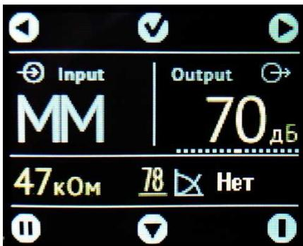
Сверху и снизу находятся по три пиктограммы, обозначающие функции сенсорных кнопок, расположенных за пределами экрана рядом с пиктограммами. Назначение кнопок следующее: сверху-слева – уменьшение
