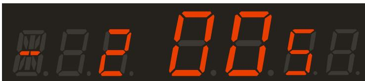
Если, пока горит эта индикация, нажать еще раз на желтую кнопку ПДУ, то индикатор покажет «15s», что означает задержку на 15 минут. Продолжая нажимать на желтую кнопку можно установить задержку на 30, 45, 60, 75 или 90 минут. После 90 индикация опять сбросится на 0, что выключит функцию.
