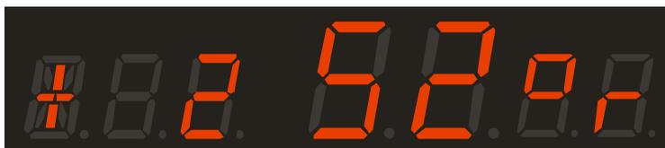
На прогревом усилителе температура левого канала индицируется на несколько градусов выше. Это связано с тем, что на нем датчик стоит выше и его лучше прогревает сам блок усилителя.
