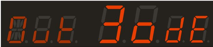
«Out» - только усилитель мощности, работающий от входа Direct.
