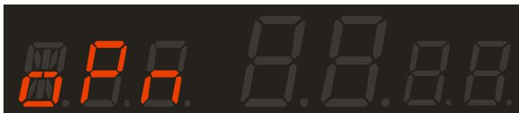
Display – включение / выключение погасания экрана:
