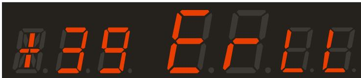
Где слева высвечивается значение уровня питания. Это не уровень напряжения в розетке, а некое внутреннее питание. Однако причина, скорее всего, пониженное напряжение в сети. Если усилитель включен на напряжение в сети 240 В, то переключите его на 220 В.
