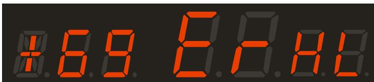
Где слева высвечивается значение уровня питания. Это некое внутреннее питание. Но причина находится в повышенном напряжении напряжения в розетке. Если усилитель включен на напряжение 220 В, то переключите его на режим 240 В.
