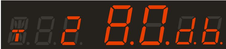
При этом индицируется уровень громкости, вход и другие настройки так, как они будут действовать после включения. Дальше производится включение выходных каскадов усилителя, что индицируется верхним средним сегментом:
