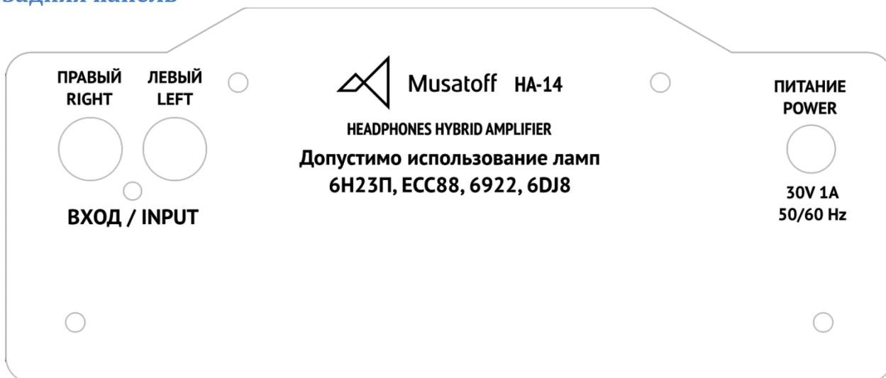
*ВХОД / INPUT* – стандартный RCA стереофонический вход
